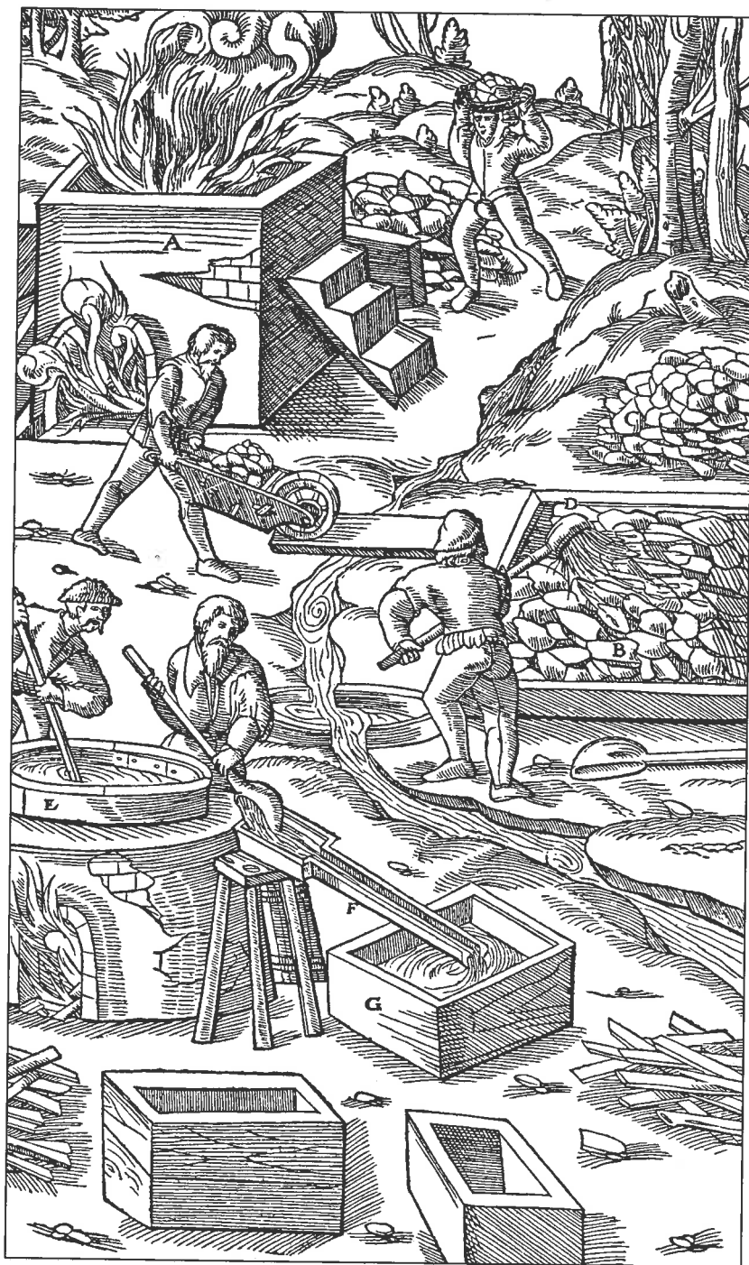
Fig. 3. La fabrication de l'alun à partir de l'alunite, selon le De Re Metallica d'Agricola.
